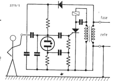
Fig. 5 - Innesco di un thyristor mediante un generatore rilassatore a lampada luminescente (Tung-Sol Electric, USA).
