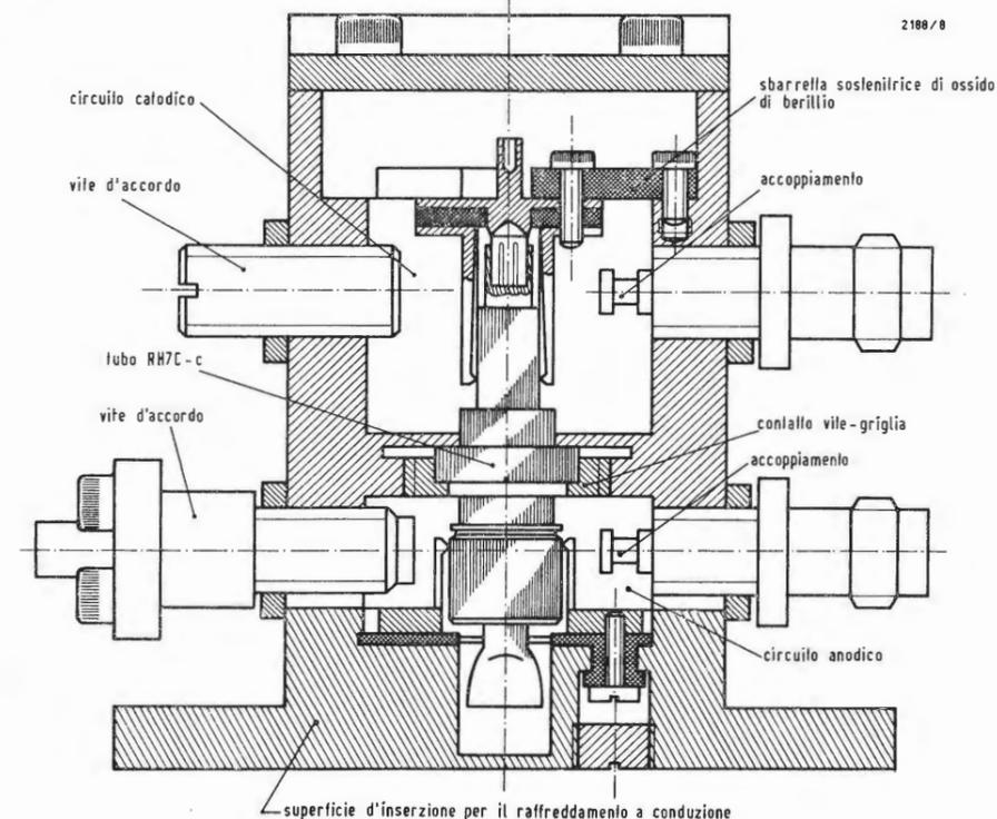
Fig. 6. - Sezione di una cavità amplificatrice con triodo a disco.
