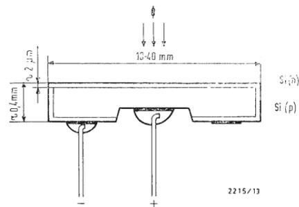
Fig. 1 - Sezione trasversale di una pila solare.
