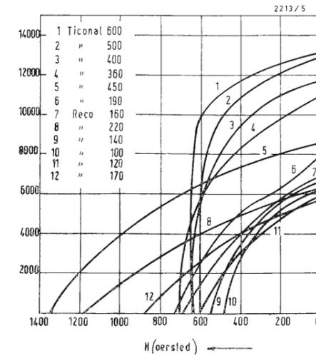
Fig. 2 - Caratteristiche di smagnetizzazione delle leghe in Reco e Ticonal.
