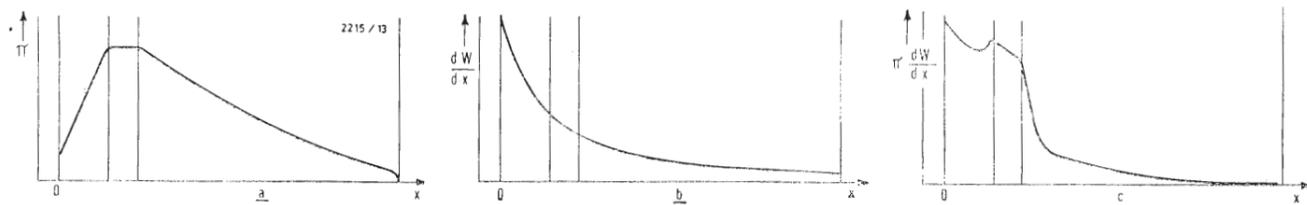
Fig. 5 - a) Dipendenza della probabilità  $\pi$  dalla distanza  $x$  della giunzione dal punto in cui il portatore di cariche viene liberato - b) Dipendenza della probabilità  $dW$  di un fotone di venire assorbito in uno strato di spessore  $dx$  e producente una coppia elettrone-cava, in funzione di  $x$  - c) Probabilità totale di un fotone, assorbito fra  $x$  e  $x + dx$  di produrre una carica misurabile.
