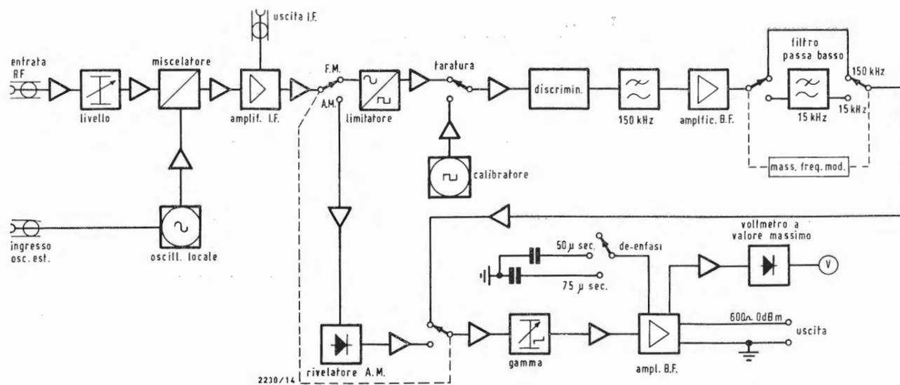
Fig. 2 - Schema a blocchi del modulometro.
