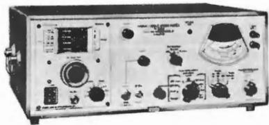
Fig. 1 - Foto del misuratore di modulazione FM-AM TF2300.
