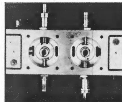
Fig. 7. - Amplificatore a due cavità.
