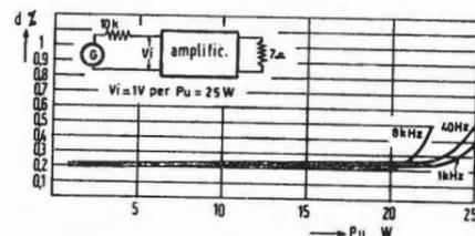
Fig. 7 - Curve di distorsione dell'amplificatore finale.
