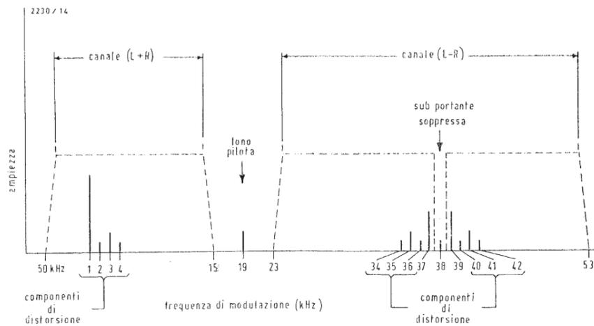
Fig. 10 - Spettro di frequenza di un segnale FM stereo con un segnale modulante di 1 kHz. La modulazione è effettuata con il sistema G.E.-Zenith.
