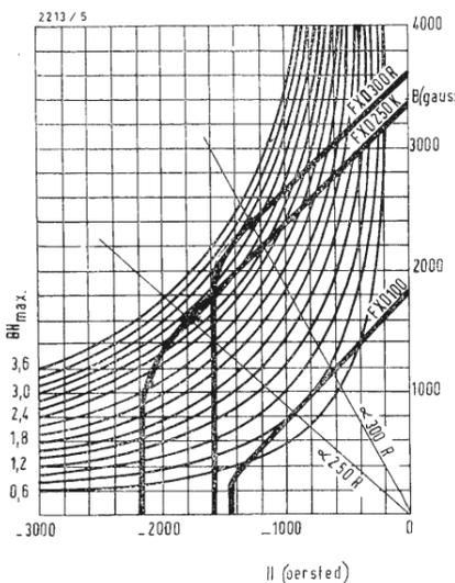
Fig. 1 - Caratteristiche di smagnetizzazione del Ferroxdure.
