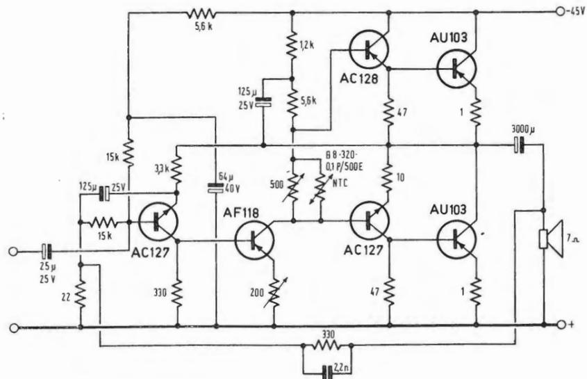
Fig. 6 - Schema elettrico dell'amplificatore di potenza da 25 W.
