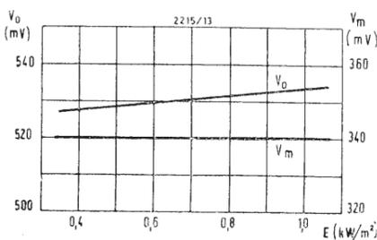
Fig. 8 - Influenza dell'illuminazione E sulla tensione V<sub>o</sub> a vuoto e sulla tensione ottima V<sub>m</sub> a carico.
