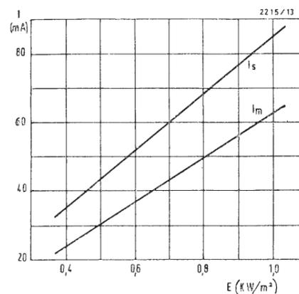
Fig. 9 - Influenza dell'illuminazione E sulla corrente I<sub>s</sub> di corto circuito e sulla corrente I<sub>m</sub> a carico.
