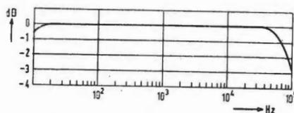
Fig. 8 - Curva di risposta in frequenza dell'amplificatore finale.
