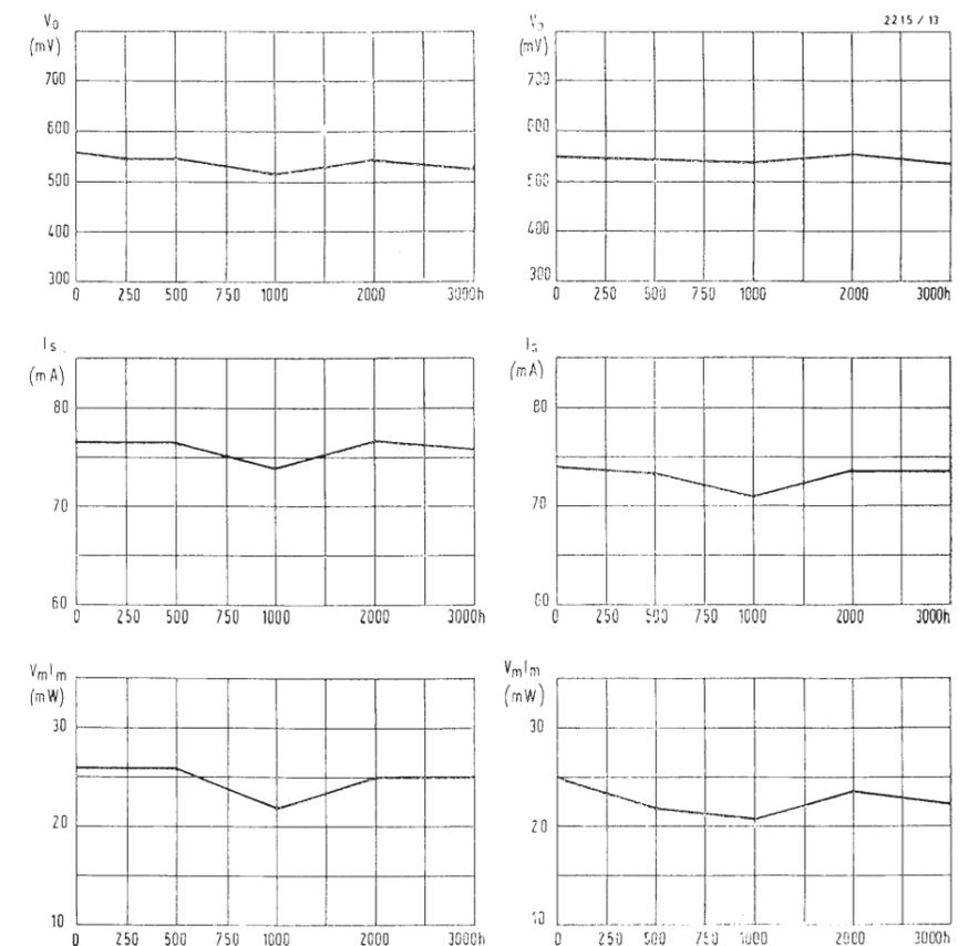
Fig. 10 - Variazioni caratteristiche di V<sub>o</sub>, I<sub>s</sub> e di V<sub>m</sub>, I<sub>m</sub> col tempo. I grafici a sinistra si riferiscono a pile tenute per 3000 ore all'aria aperta, quelli a destra a pile funzionanti a carico.
